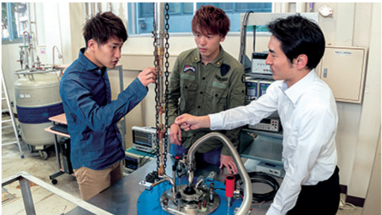
極低温状態において量子ビットの評価を行う実験の準備にとりかかる小寺准教授、田所さん、溝口さん(写真右から)。大きな磁場が必要となる実験では、こちらの大型(地下2メートル)の冷凍機を使用する。
