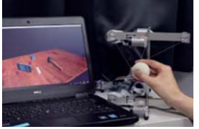
カセンサーを握ったり動かすことでVR空間の2点を操作して物体が狙える。そのときの反力の感覚を提示することは長谷川准教授が最初に取り組んだ研究だ。
