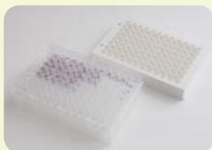
一度に大量の化合物について薬の効果を確かめる際に使用する「96穴プレート」
