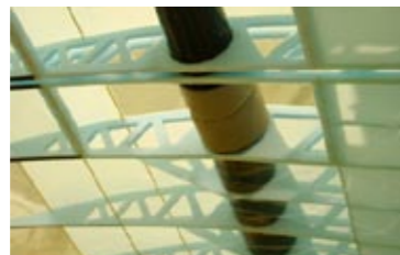
Meisterの機体の翼部分。パイプの材料はカーボン
