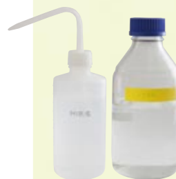
左：不純物が一切なく、無菌状態の「超純水」。実験で溶液の希釈や、器具の洗浄に使用します/右：DNAやタンパク質などの生体分子を電気泳動する際に使用する「TAE緩衝液」
