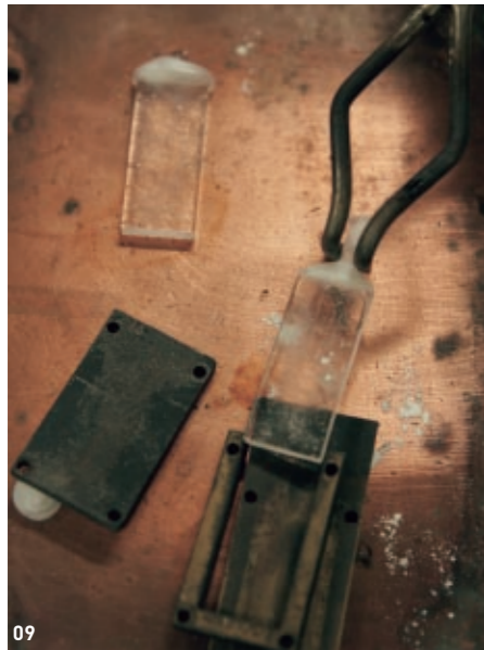
09: 実験用高炉で熱し、鑄型に流し込んで再現したモールドフラックス。熱を失うとガラスのように透明になる。／10, 11: スクラップ鉄のリサイクル研究において、鉄の被膜に銅がどれほど溶け込むか（銅の「濡れ性」）を計る実験装置（10）。鉄被膜上の銅の厚にレーザーで光を当てて撮影し、電角（11）を計測する。
