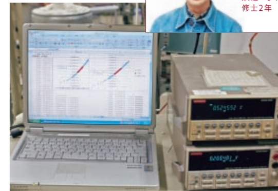
モールドフラックスの電圧、電流、抵抗、周波数、温度などの値と時間変化を計測する。
