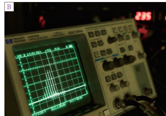
A: 10兆分の1秒での時間分解分光測定に用いる光学系の一部。/ B: 再生増幅型フェムト秒パルスレーザーの動作確認のために、光パルス増幅過程を観測。/ C: 時間分解分光測定に用いる光パルス(繰り返し1キロHz)のタイミング調整。
