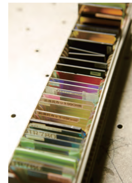
非線形光学効果により様々な色に変えたレーザー光から、測定に不要な色の光を遮るための各種フィルター類。
