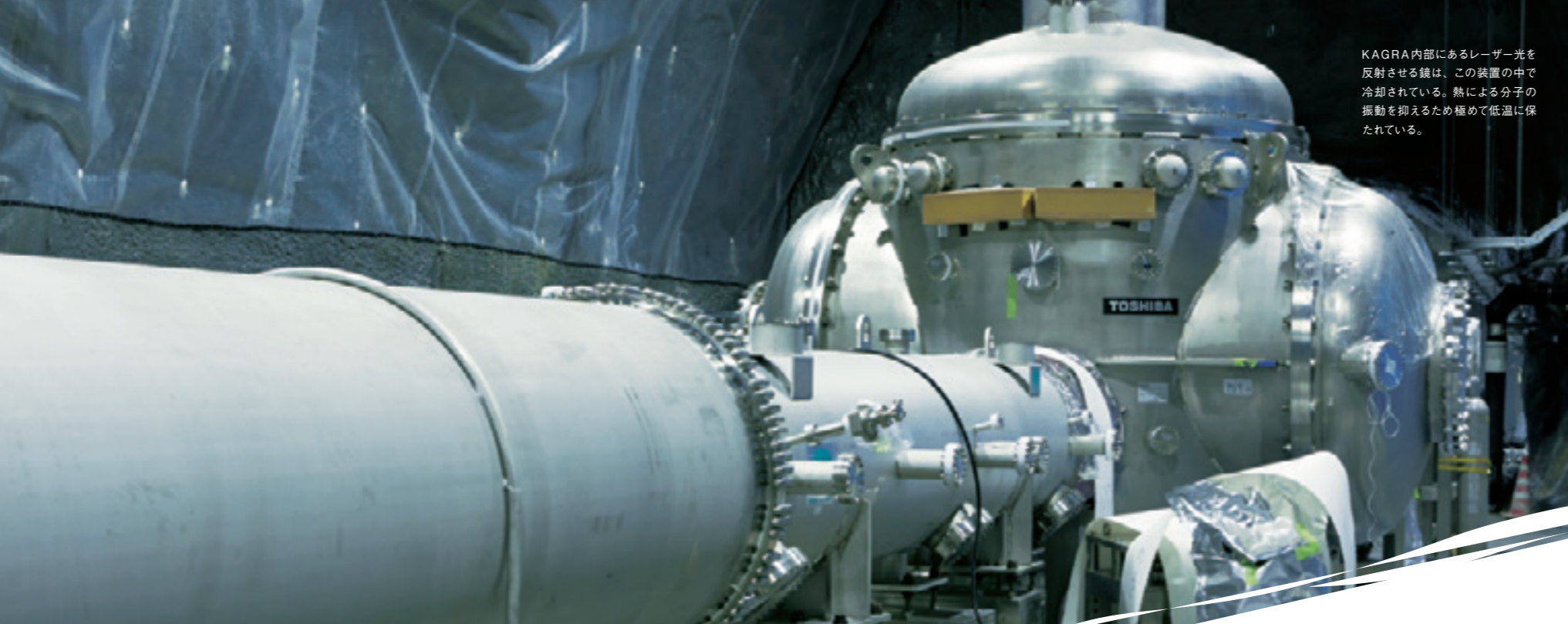
大岡山キャンパスの宗宮研究室につくられた実験装置。KAGRAと同じものを、スケールを小さくして再現している。これで何度も検証実験を行う。
