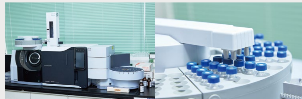
▲ (左・右とも) 匂い物質に含まれる成分を分析する際にも使われる、ガスクロマトグラフ質量分析装置
